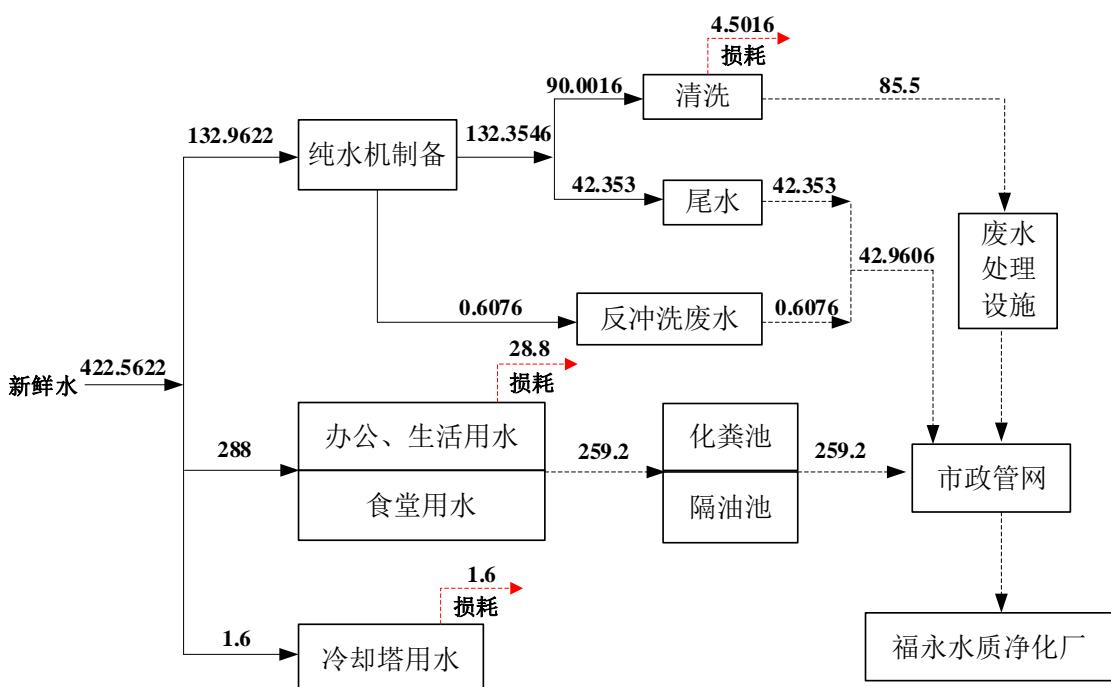
图 2-1 项目水平衡图 (m<sup>3</sup>/d)
