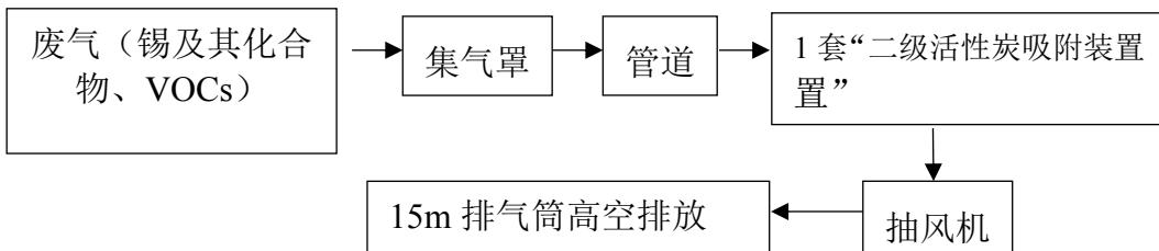
图 4-2 项目 (DA13) 废气处理工艺流程图
