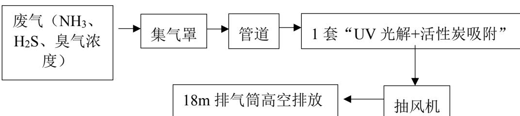
图 4-3 项目 DA017 废气处理工艺流程图
