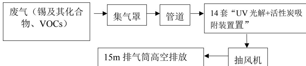
图 4-1 项目 (DA002、DA003、DA005、DA006、DA007、DA008、DA009、DA011、DA012、DA014、DA015、DA016、DA017、DA019) 废气处理工艺流程图
