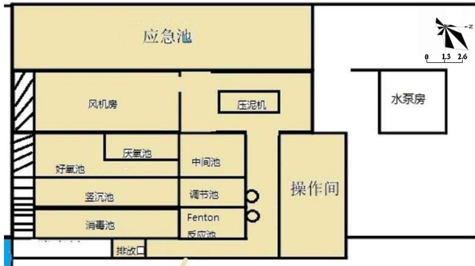
72m<sup>3</sup>/d 废水处理设施 (TW002) 平面布置图:
