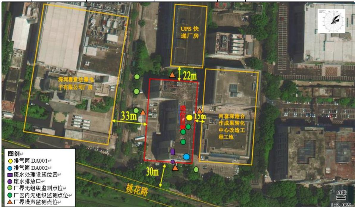
图 3-3 废水、废气、噪声环境监测点布置图
